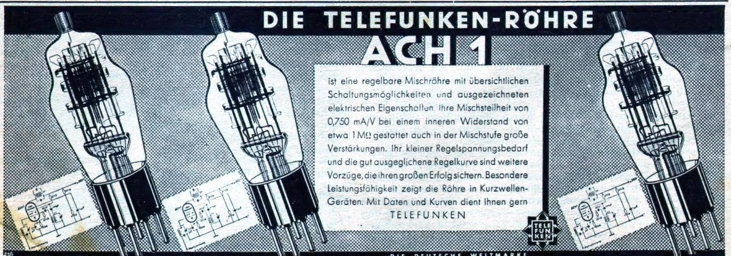
ist eine regelbare Mischröhre mit übersichtlichen Schaltungsmöglichkeiten und ausgezeichneten elektrischen Eigenschaften. Ihre Mischsteilheit von 0,750 mA/V bei einem inneren Widerstand von etwa 1 M $\Omega$  gestattet auch in der Mischstufe große Verstärkungen. Ihr kleiner Regelspannungsbedarf und die gut ausgeglichene Regelkurve sind weitere Vorzüge, die ihren großen Erfolg sichern. Besondere Leistungsfähigkeit zeigt die Röhre in Kurzwellengeräten. Mit Daten und Kurven dient Ihnen gern
